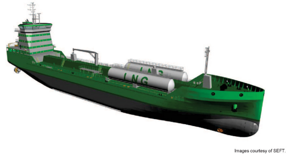
Fig. 2. Hull-independent tank on an LNG carrier [4]
