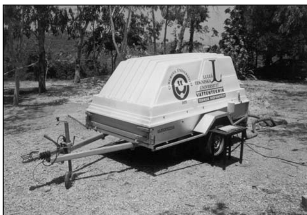
Sl. 1. Naprava za merjenje TTO Fig. 1. In-situ TRT apparatus
