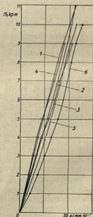
Sl. 4. Skrčki merilne puše \Delta l pri privijanju z momentom M_1
