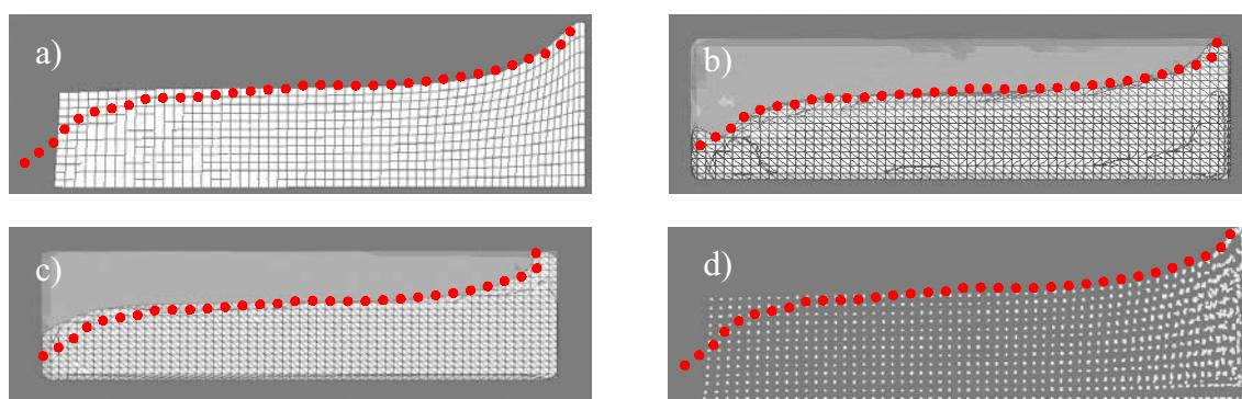
Sl. 9. Oblika proste površine: a) Lagrangev model; b) Eulerjev model; c) PLE model; d) MHDZ model
