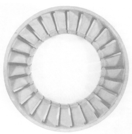
Sl. 3. Komponente plinske turbine avtomobilskega motorja iz SiC [3]
