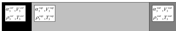
Sl. 2. Shema modela eksplozije pare (črna – staljena sredica, svetlo siva – para, temno siva – kapljevita voda, pikčasta siva – kapljevita voda v mikrointerakcijski coni)
