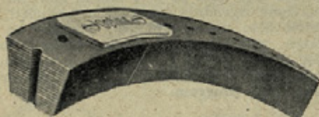
Sl. 30. Klinasti jermen Optimat z luknjicami za izvedbo spoja. Zgornjo in spodnjo vezno ploščico držita skupaj vijaka
