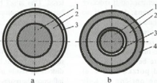
Sl. 11. Vibrirajoča valja mehanizma RTM: a – pritrjeni valj (1); b – vrteči se valj (2); 1 – os, ki je trdno pritrjena na osovo; 2 – piezokeramični obroč; 3 – elastični torni obroč; 4 – tesno prilegajoči se obročasti pokrov, ki ga ovija gibki jermen
