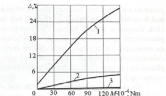
Sl. 22. Krivulje odvisnosti vrtlne nesinhronosti rotorjev od moči zunanjega obremenitve enega od rotorjev  $\Delta = f(M)$ , ko je  $U = \text{konst.} = 50 \text{ V}$ : 1 - za primer dveh rotorjev, ki nista povezana z
