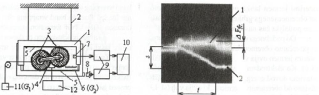
Sl. 14. Eksperimentalno ogrodje za raziskovanje mehanizma RTM z vibrirajočima valjema (1 – ogrodje; 2 – ploska vzmet; 3 – vibrirajoča valja; 4 – plošča; 5 – gibki jermen; 6 – utež (sila  $G_2$ ); 7,8 – elementa za zaznavanje gibanja; 9 – ojačevalnik signala; 10 – zapisovalna enota; 11 – utež (sila  $G_1$ ); 12 – visokofrekvenčni tok in značilni osciloskopogram gibanja ogrodja ter vibrirajočih valjev preučevanega mehanizma RTM
