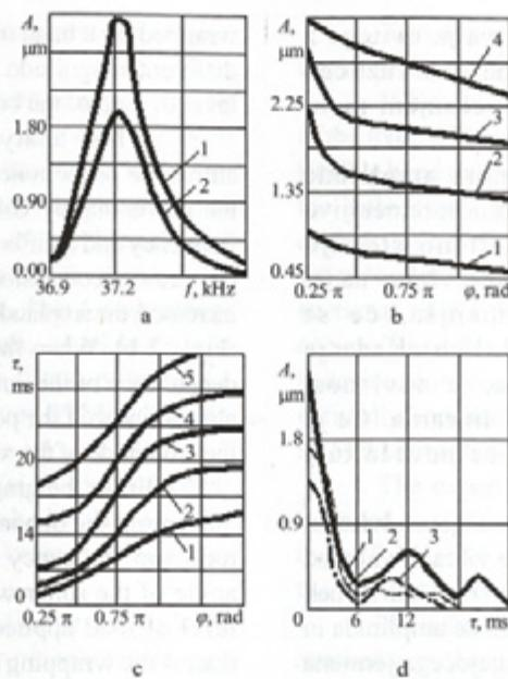
Sl. 13. Krivulje eksperimentalne raziskave vibrirajočega valja 2, ovitega s tesno prilegajočim se (obremenjenim) jermenom: a -  $A = f(f)$  - velja za montirani piezokeramični obročasti element (sl. 2 b), ko je  $U = 60$  V; 1 - velja za delovno površino piezokeramičnega obroča; 2 - velja za zunanjo površino togega obročastega pokrova 4
