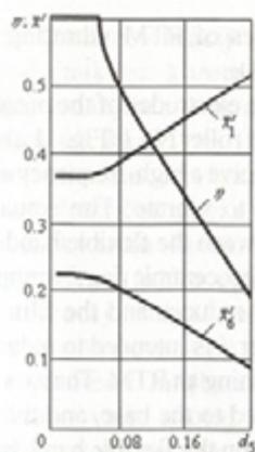
Sl. 9. Prikaz odvisnosti povprečnih hitrosti gibanja teles in izkoristka od parametrov vibracijskega vzbujanja, ko je  $f_0 = 1,0$
