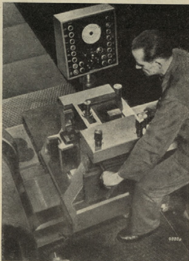
Sl. 1. Lamelni suport kopirne stružnice za obdelavo valjev
