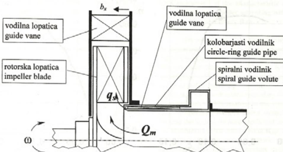
Sl. 1. Sklop za dovajanje sekundarnega toka na vstopu v rotor ob pokrovni steni
