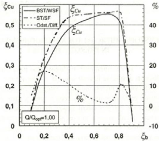
Sl. 7. Prečni hitrostni -  $\xi_{Cu}$  profil pri  $Q/Q_{opt} = 1,00$  in  $n = n_{opt}$
