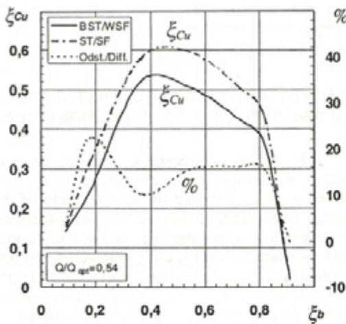
Sl. 6. Prečni hitrostni -  $\xi_{Cu}$  profil pri  $Q/Q_{opt} = 0,54$  in  $n = n_{opt}$
