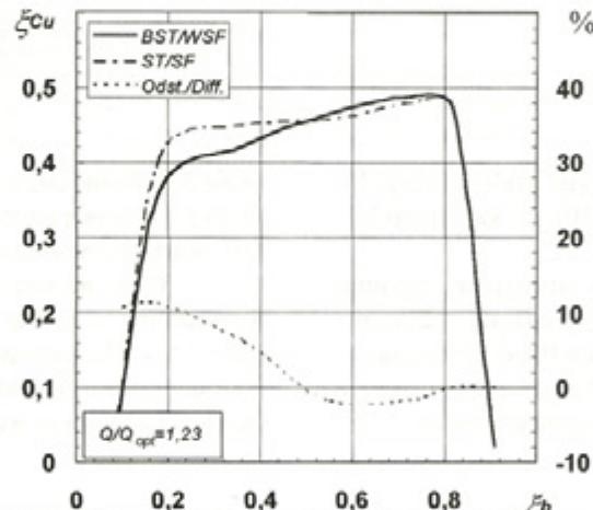
Sl. 8. Prečni hitrostni -  $\xi_{Cu}$  profil pri  $Q/Q_{opt} = 1,23$  in  $n = n_{opt}$
