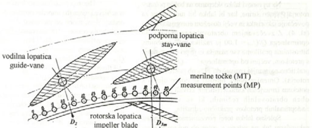
Sl. 5. Merilni sektor na izstopu iz rotorja na merilnem premeru  $D_{3m}$
