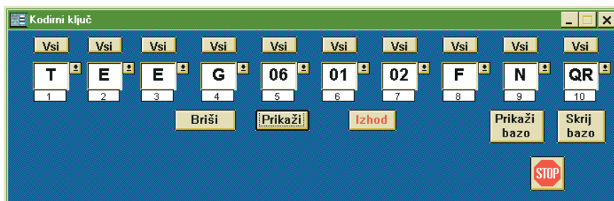
Sl. 2. Primer izpolnjene osnovne maske, za izbiro rezalnih ploščic za struženje po standardu ISO 1832-1985
