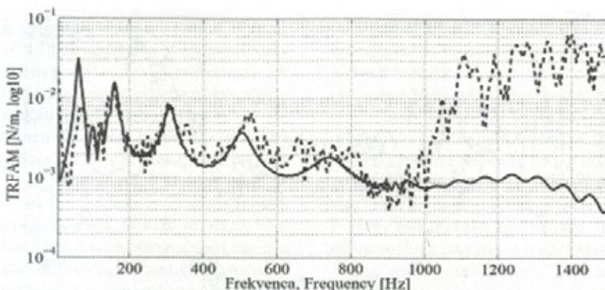
Sl. 12. TRFAM pri uporabi mehanskega filtra, PRIMER 1; (—) brez meh. filtra, (- -) z meh. filtrom
