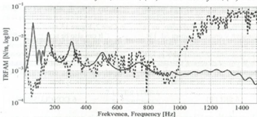
Sl. 13. TRFAM pri uporabi mehanskega filtra, PRIMER 2; (—) brez meh. filtra, (- -) z meh. filtrom
