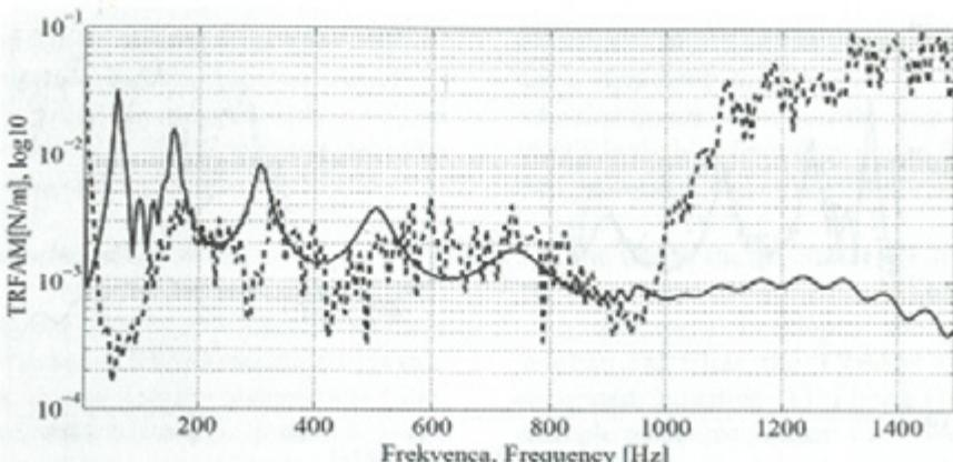
Sl. 15. *TRFAM pri uporabi mehanskega filtra, PRIMER 4; (—) brez meh. filtra, (- - -) z meh. filtrom*
