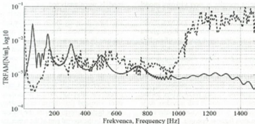
Sl. 14. TRFAM pri uporabi mehanskega filtra, PRIMER 3; (—) brez meh. filtra, (- -) z meh. filtrom
