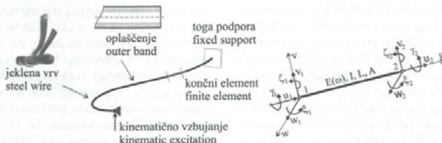
Sl. 2. Fizikalni model jeklene vrvi in oplaščenja; uporabljen končni element
