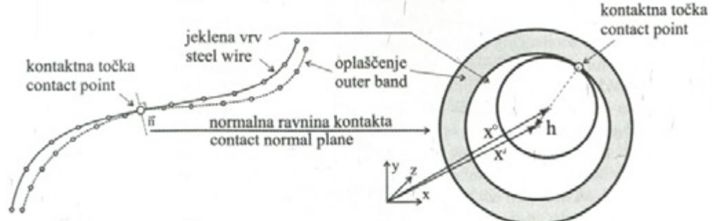
Sl. 9. Kontaktna točka vzdolž jeklene vrvi v radialni smeri
