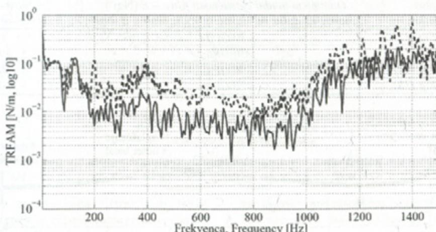
Sl. 10. TRFAM jeklene vrvi in oplaščenja: zračnost (—)  $e=1,5 \cdot 10^{-4} \text{ m}$  in (--)  $e=6,5 \cdot 10^{-4} \text{ m}$
