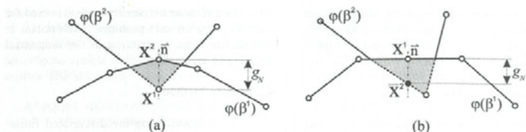
Sl. 8. Definicija vektorja normale v kontaktni točki: (a) vozlišče - vozlišče, vozlišče - krivulja
