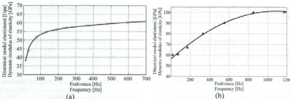
Sl. 4. Frekvenčna odvisnost dinamičnega modula elastičnosti: (a) jeklene vrv, (b) oplaščenje
