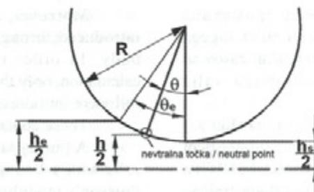
Sl. 4. Parametri za metodo SLAB
