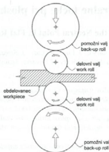
Sl. 1. Sistem štirivaljnega opornega valjanja
