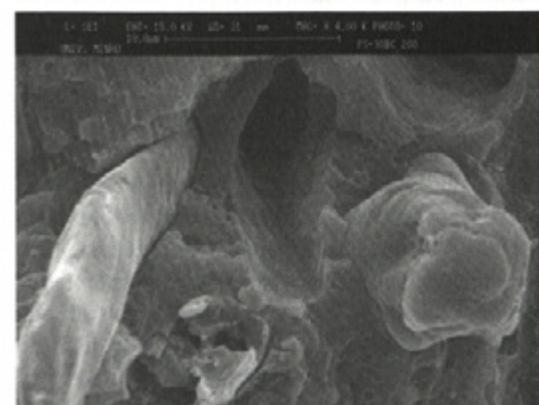
Sl. 3. PS + 30 % celuloznih vlaken, posneto z elektronskim mikroskopom, povečava 4000X
