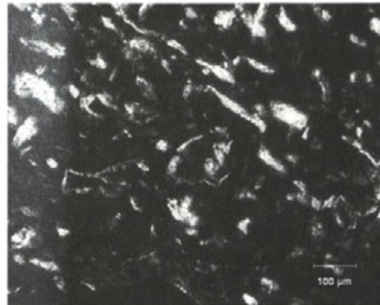
Sl. 2. Prikaz PS s 30 % celuloznih vlaken, povečava 200X, optični mikroskop
