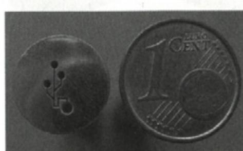
Sl. 4. Elektroda za PPME, izdelana z VC
