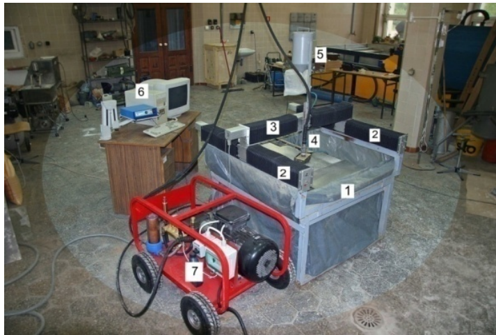
Sl. 2. Preizkuševališče za prostorsko obdelavo materiala z visokotlačnim abrazivnim vodnim curkom: 1) ogrodje, 2) vodila po osi y, 3) vodila po osi x, 4) delovna glava abrazivnega vodnega curka, 5) posoda za abraziv, 6) osebni računalnik za krmiljenje, 7) visokotlačna vodna črpalka tip As500/15A
