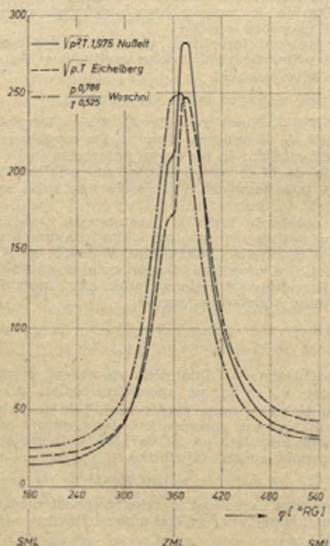
Sl. 1. Krivulje parcialne toplotne prestopnosti v obliki \sqrt{p \cdot T} , \sqrt{p \cdot T} in p^{0,786} \cdot T^{-0,525} za določen potek tlakov in temperatur delovnih plinov motorja MAN KV 30/54, reduciranih na enako srednjo vrednost
