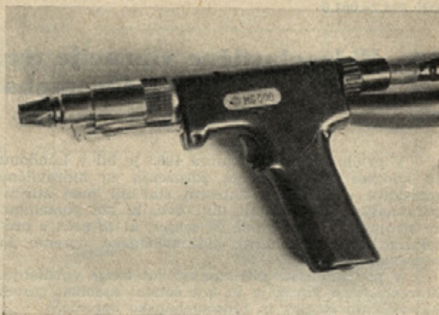
Sl. 22 a. Pištola za polavtomatično varjenje po postopku MIG (MAG)
