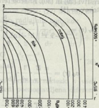
Sl. 3. Napetosti v kratkem valju (termična obremenitev)
