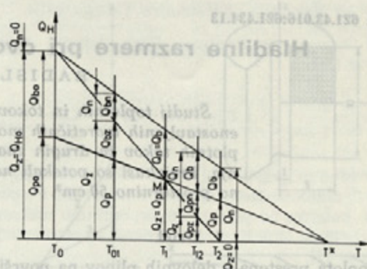
Sl. 2. Toplotni tokovi na »teoretičnem modelu z neskončno toplotno prevodnostjo materialov«
