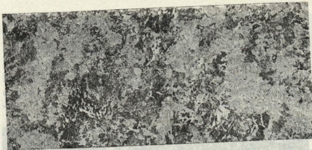
Sl. 21. Heterogena struktura v jedru enega od zob: martenzit in bainit (100 : 1)
