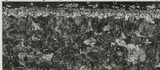
Sl. 17. Razogljčena in notranje oksidirana površina na kontrolnem vzorcu jekla (pov. 200 : 1)
