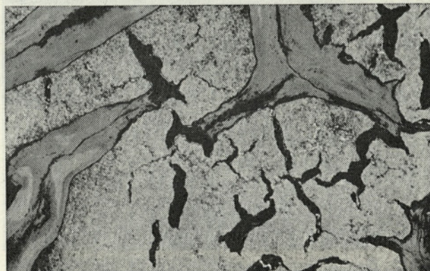
Sl. 10. Potek razpok prečno na smeri vlaken na delovni površini bata (30 : 1)
