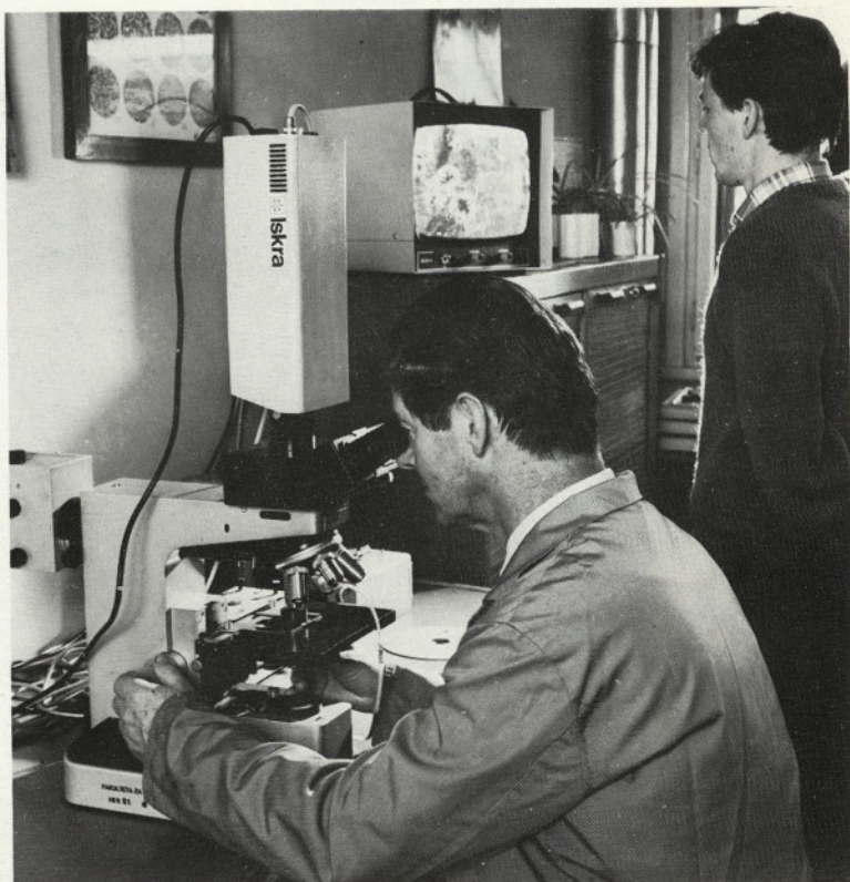
Merilna veriga za raziskave zaostalih napetosti, razvita v laboratoriju PRE za tehnologijo materialov
