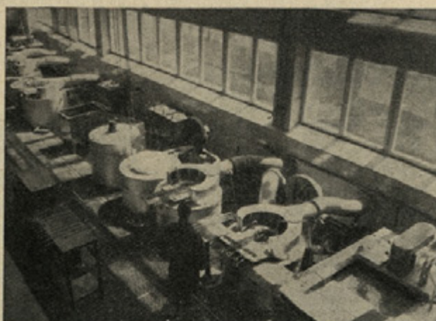
Sl. 8. Del kalilnice s solnimi kopelmi Durferrit, ogrevanimi z oljem
