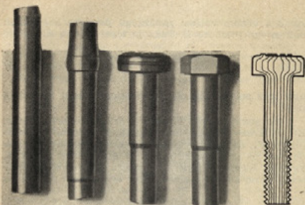
Sl. 2. Šele z uvedbo hladnega preoblikovanja vlečene žice je bila ustvarjena ekonomična osnova za množinsko in ceneno izdelavo kvalitetnih vijakov. Slika kaže posamezne faze izdelave, od žice do končne oblike, ko je za termično obdelavo na vrsti zadnja faza — uvaljanje navoja v hladnem stanju. Izmeček materiala je neznaten (2%). Vlakna potekajo neprekinjeno in v stebli ni ostrih zarez ali prehodov
