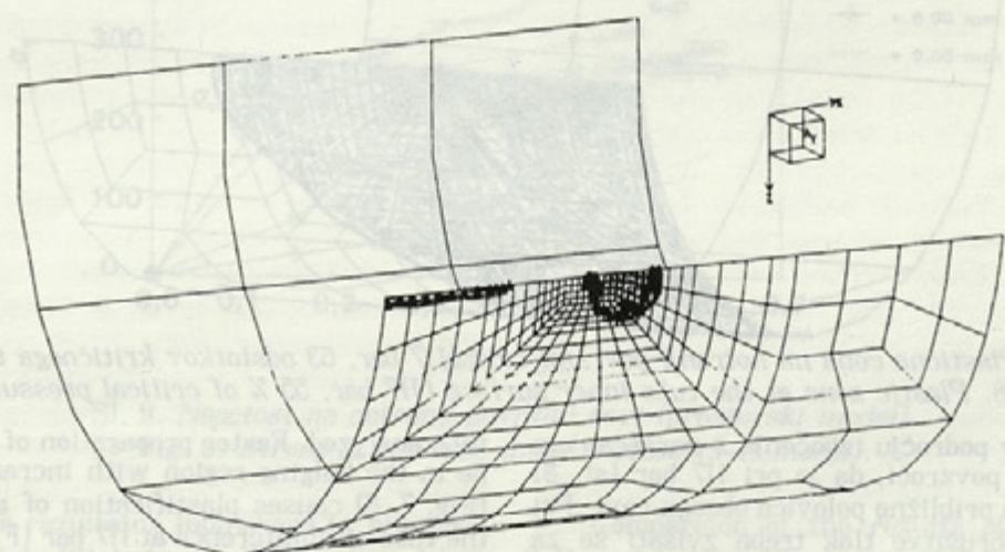
Sl. 5. Plastična zona na notranji površini cevi (60 bar, 32 %  $p_c$ ).Fig. 5. Plastic zone at the tube inner surface (60 bar, 32 %  $p_c$ ).
