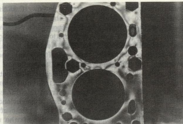
Sl. 1. Primer obremenitve modela (tlak v valju 50 bar).
