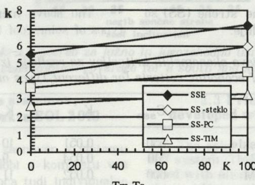
Sl. 6. Toplotne prehodnosti  $k$  ( $\text{W/m}^2\text{K}$ ) standardnih SSE in sončne strehe z različnimi kritinami v odvisnosti od razlike temperature med sprejemnikom in okoljem
