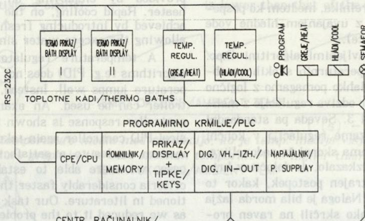
Sl. 4. Blokovna shema sistema za umerjanje in nadzor termostatov
