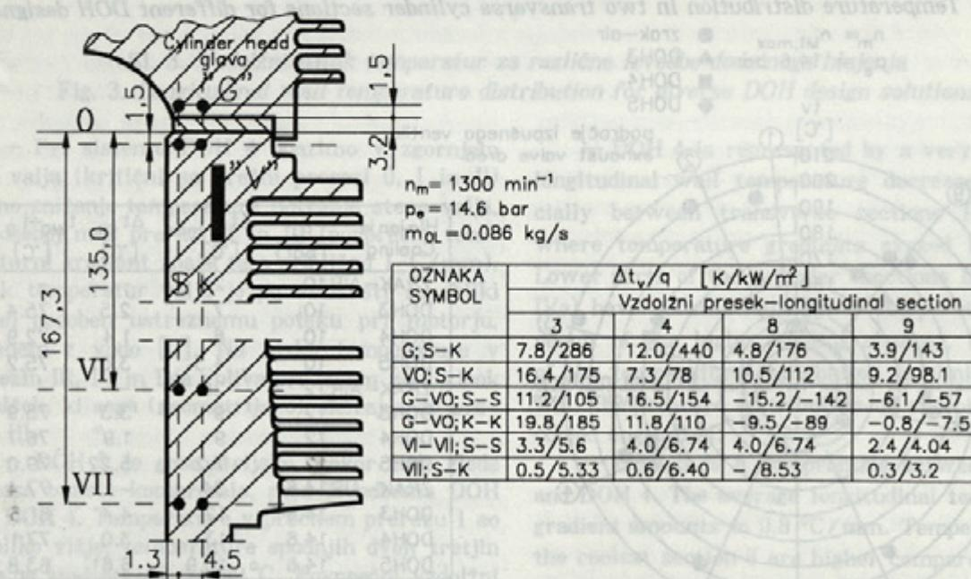
Sl. 6. Lega diferenčnih temperaturnih zaznaval, temperaturne razlike ter gostote toplotnega toka v glavi in valju s hljenjem DOH 5
