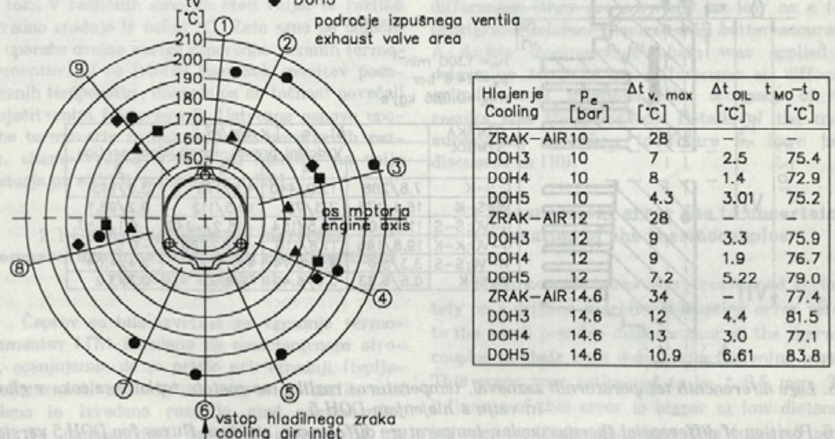
Sl. 5. Potelek temperatur po obodu stene valja za različne obremenitve motorja in različne izvedbe DOH
