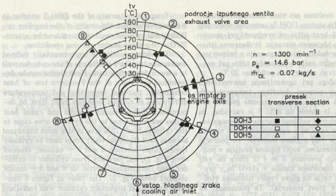
Sl. 4. Potelek temperatur v dveh prečnih prerezih stene valja za različne izvedbe DOH
