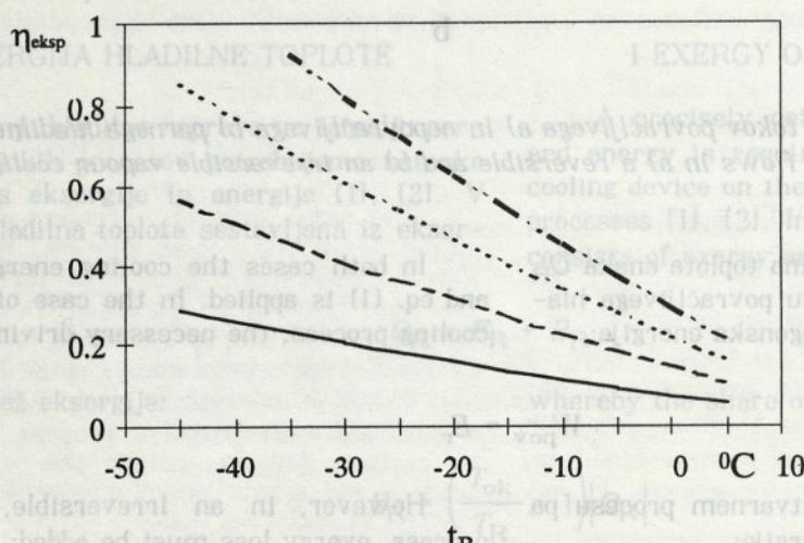
Sl. 3. Odvisnost eksergijskega izkoristka parnega hladilnega procesa od temperature hlajenja in hladilnega števila
