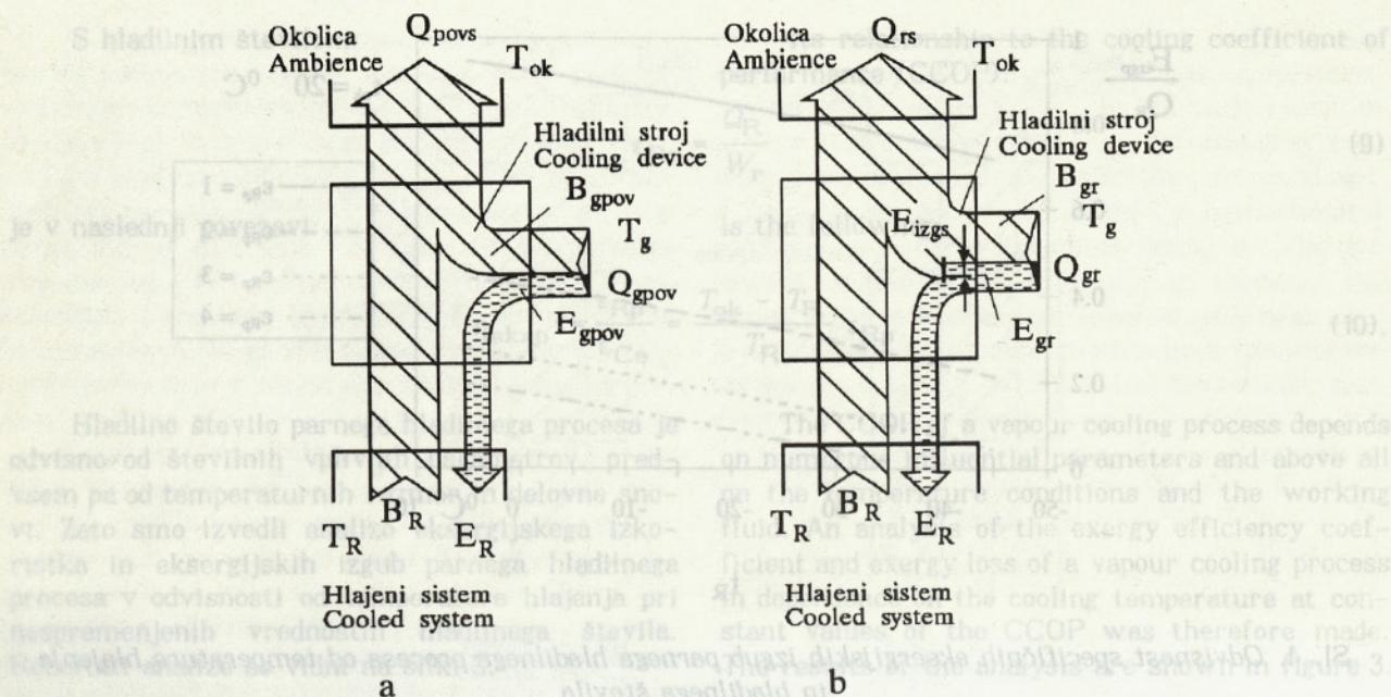
SI. 5. Diagram energijskih tokov povračljivega a) in nepovračljivega b) sorpcijskega hladilnega procesa
