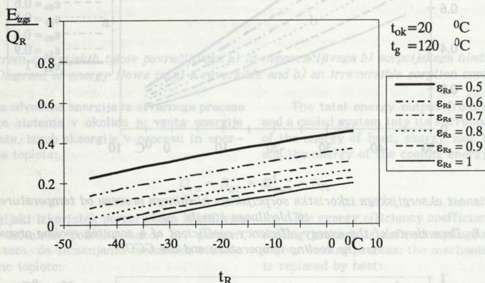
Sl. 8. Specifične izgube eksergije sorpcijskega hladilnega procesa v odvisnosti od temperature hlajenja in hladilnega števila
