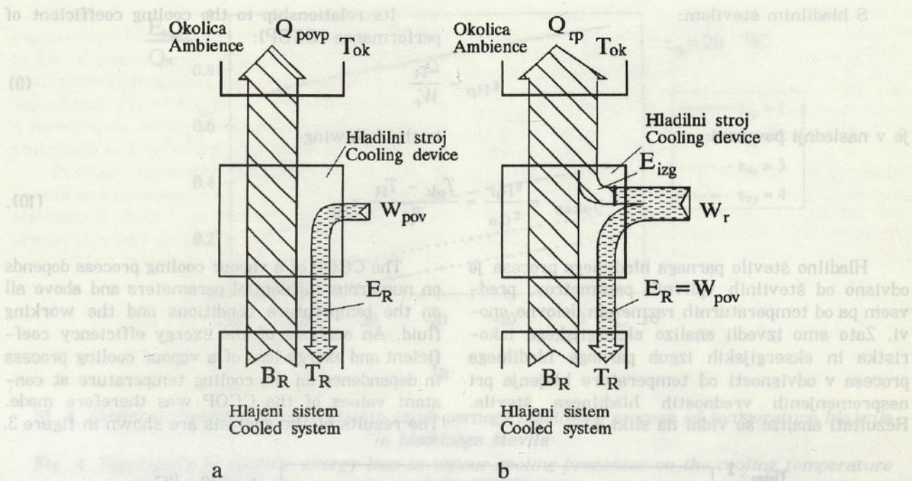
Sl. 2. Diagram energijskih tokov povračljivega a) in nepovračljivega b) parnega hladilnega procesa
