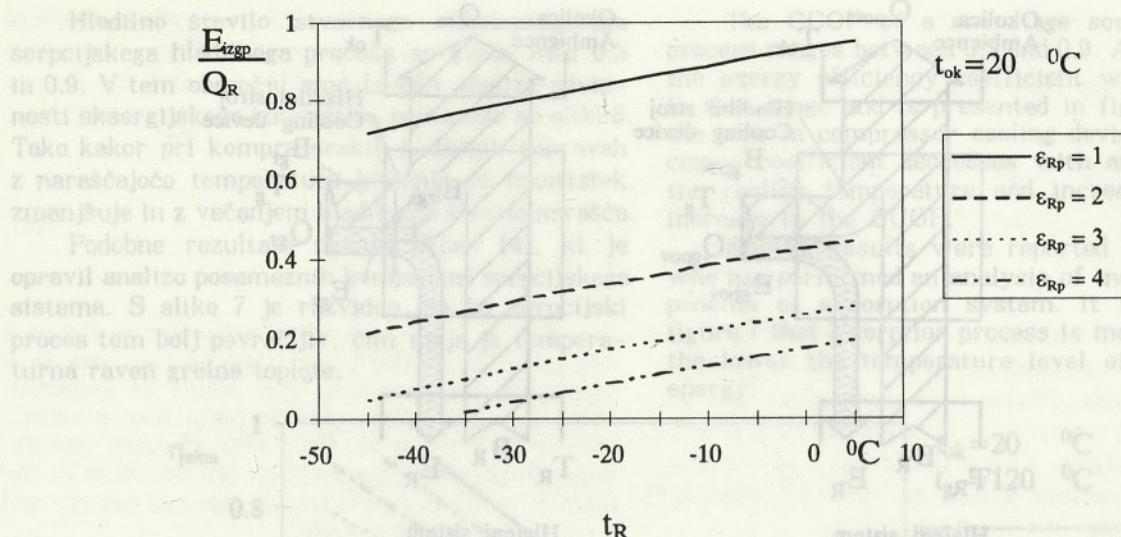
Sl. 4. Odvisnost specifičnih eksergijskih izgub parnega hladilnega procesa od temperature hlajenja in hladilnega števila
