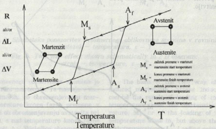
Sl. 4. Shematski prikaz spremenjanja lastnosti materiala z oblikovnim spominom ob faznih premenah iz avstenita v martenzit in nasprotno [14]
