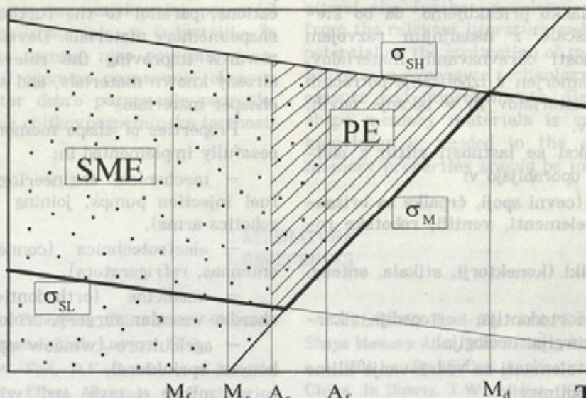
Sl. 8. Shematski prikaz področja enosmernega oblikovnega spomina (SME) in področja psevdoelastičnosti (PE) v odvisnosti od napetosti in temperature,  $\sigma - T$  [4]Fig. 8. One way effect region (SME) and pseudoelasticity region (PE) dependence on stress and temperature,  $\sigma - T$ , shown schematically [4]
