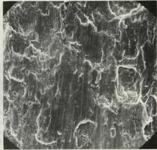
Sl. 6. Mikrografija v delu preloma 2 (sl. 4); raze so znak oblike površine jeklene plošče pred spajanjem ter žilav, jamičast prelom (pov. 600 ×)
