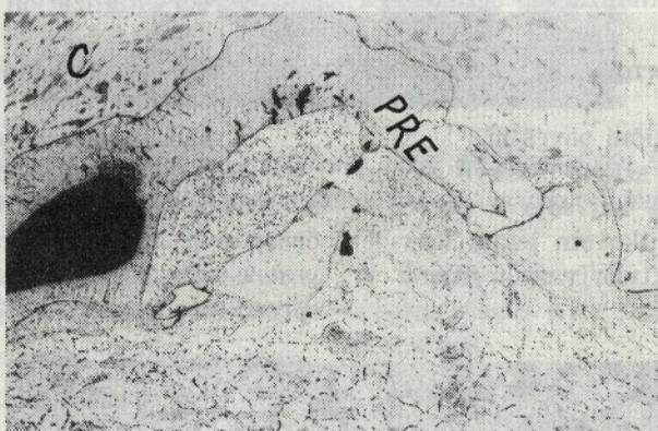
Sl. 9. Mikrolunker v pretaljeni kovini na spoju jeklenih pločevin; (pov. 100 ×)
