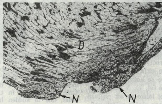
Sl. 7. Mikrostruktura ogljikovega jekla na spojni črti; močno plastično deformirano jeklo (D) z dvema otokoma prekristaliziranega (normaliziranega) jekla (N) (pov. 200 ×)
