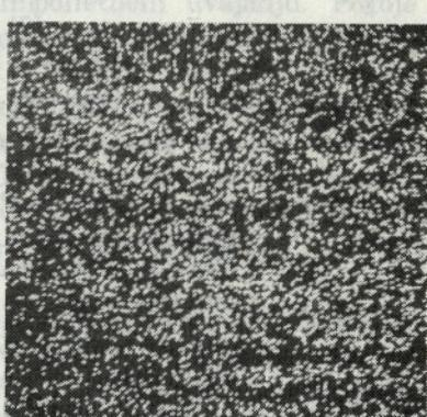
Sl. 11. Mikrokemična analiza otoka pretaljene kovine na spoju jeklenih plošč; porazdelitev železa (Fe) in legirnih elementov v okolici spoja (Mn, Ni, Cr, Si; levo zgoraj slika sekundarnih elektronov)
