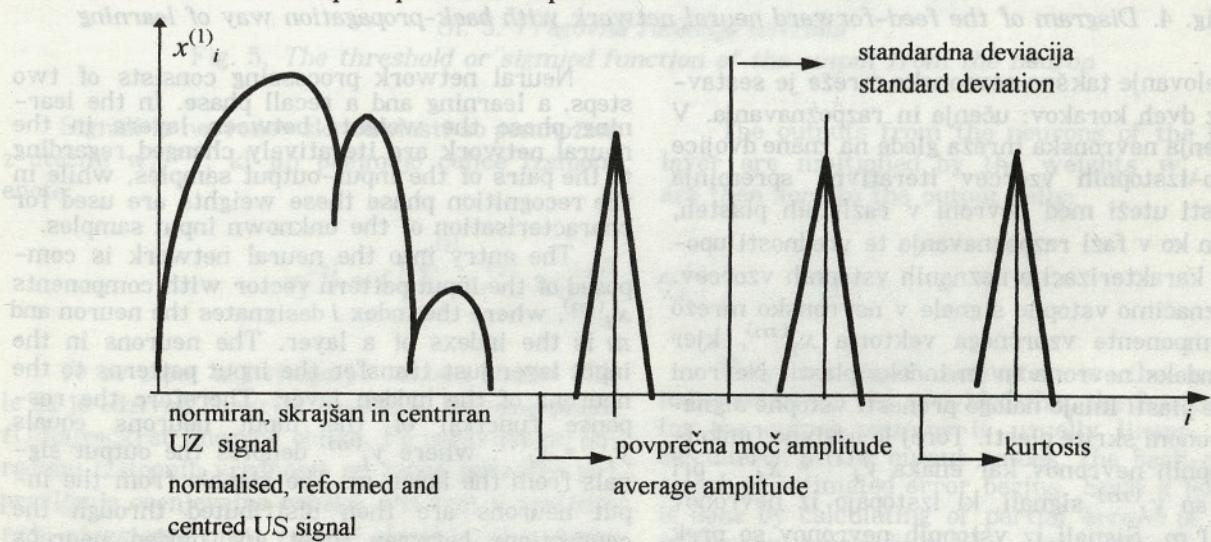
Sl. 3. Vhodni vzorčni vektor, rezultat predprocesiranja ultrazvočnih signalov
