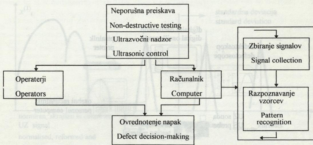
Sl. 1. Shematičen prikaz običajnega in avtomatiziranega nadzora kakovosti materiala
