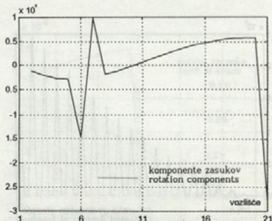
Sl. 14. Komponente zasukov vektorja  $R_2$  za primer dodatne mase
