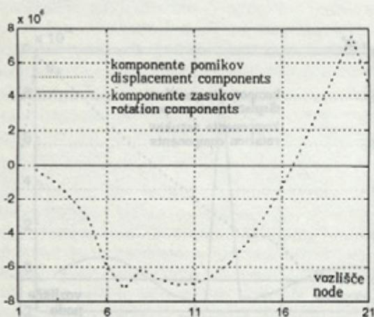
Sl. 13. Vektor  $R_2$  za primer dodatne mase, razdeljen po komponentah; pomiki spet prevladujejo
