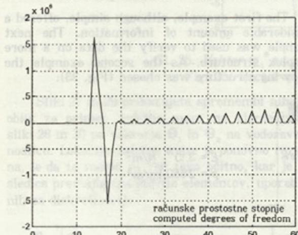
Sl. 19. Vektor  $R_1$  za primer povečanja prereza elementa 5; motnja je očitna
