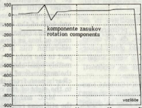
Sl. 12. Komponente zasukov vektorja  $R_1$  za primer dodatne mase
