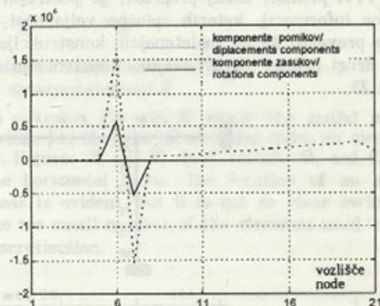
Sl. 20. Komponente vektorja  $R_1$ ; komponenti zasukov in pomikov izkazujeta lokacijo motnje
