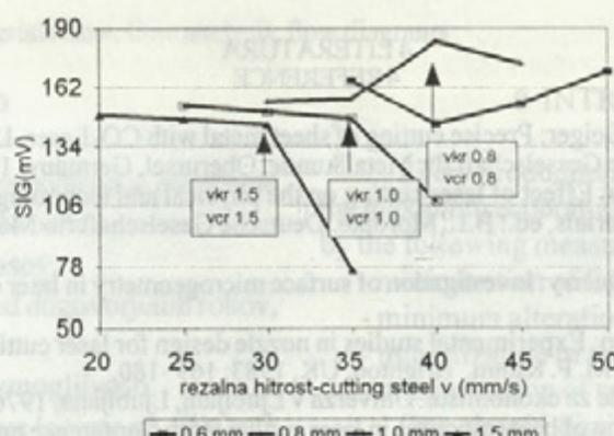
Sl. 7. Določevanje mejnih rezalnih hitrosti laserskega rezanja pri različnih debelinah pločevine avstenitnega nerjavnega jekla
