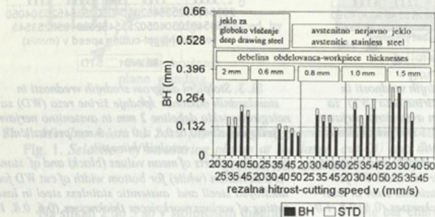
Sl. 6. Stolpični diagram srednjih vrednosti in standardnih odklonov višine srha (BH) za nelegirano jeklo debeline 2 mm in avstenitno nerjavno jeklo debeline 0,6, 0,8, 1,0 in 1,5 mm pri različnih rezalnih hitrostih
