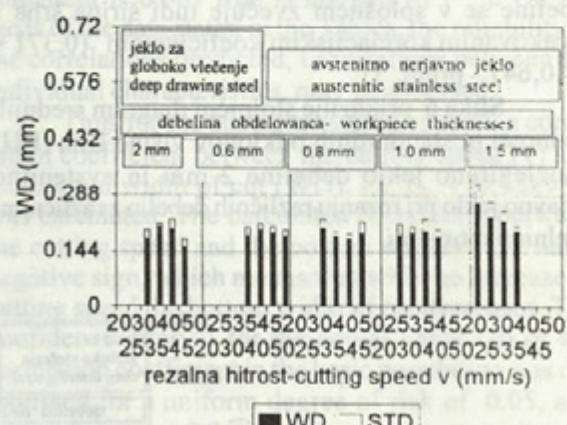
Sl. 3. Stolpični diagram srednjih vrednosti in standardnih odklonov spodnje širine reza (WD) za nelegirano jeklo debeline 2 mm in avstenitno nerjavno jeklo debeline 0,6, 0,8, 1,0 in 1,5 mm pri različnih rezalnih hitrostih
