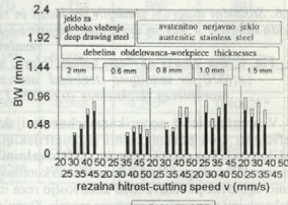
Sl. 4. Stolpični diagram srednjih vrednosti debeline pretaljenega sloja (TM) pri rezanju avstenitno nerjavnega jekla debeline 0,6, 0,8, 1,0 in 1,5 mm pri različnih rezalnih hitrostih
