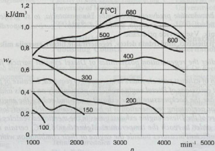
Sl. 1. Odvisnost temperature izpušnih plinov od obremenitve in hitrosti vrtenja dizelskega motorja
