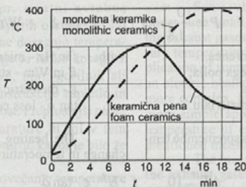
Sl. 6. Sprememba temperature na površini filtra med obnavljanjem
