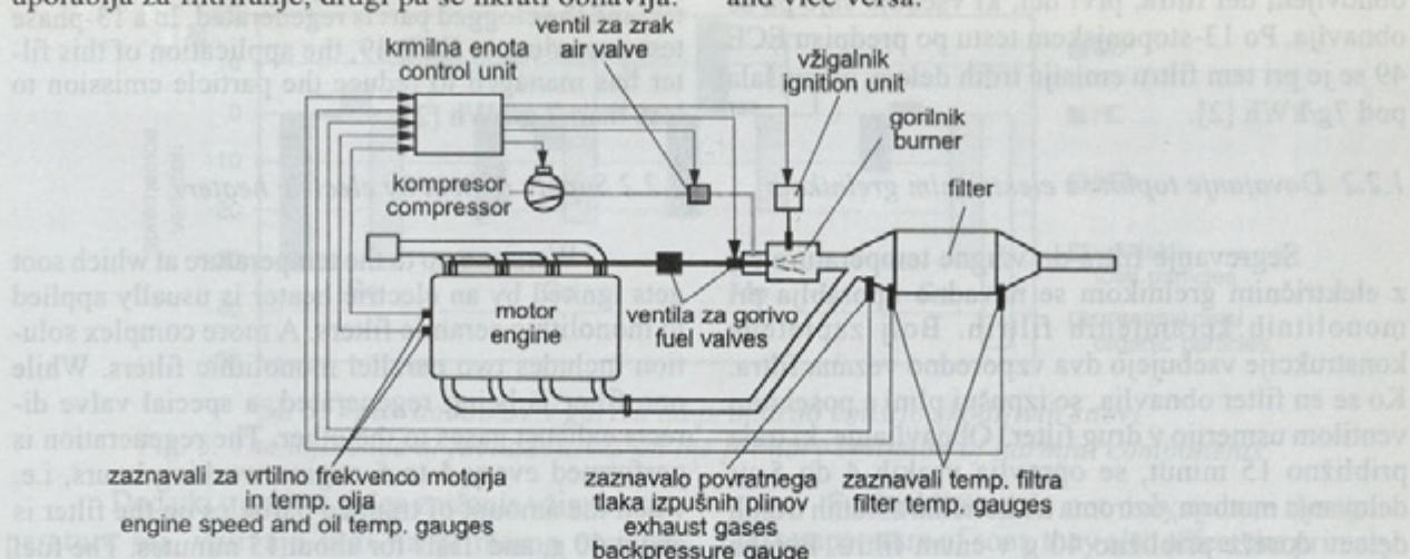
Sl. 2. Shema naprave za obnovo filtra z gorilnikom
