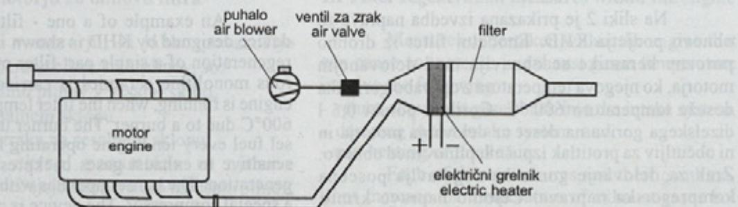
Sl. 4. Shema filtra za obnavljanje z električnim grelnikom
