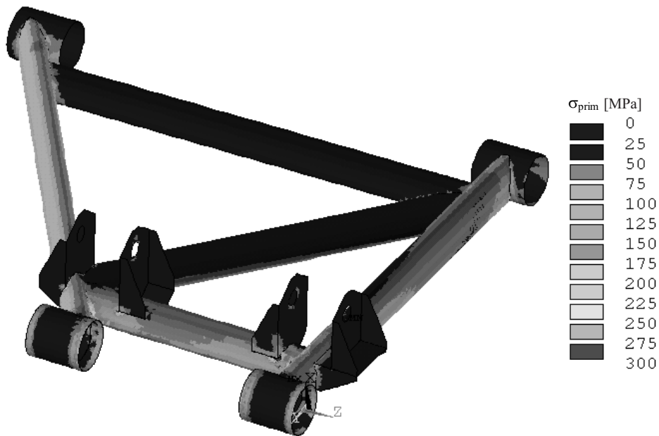
Sl. 11. Primerjalne napetosti na obesi 4 za obremenitveni primer i=43 Fig. 11. Equivalent stress on wishbone 4 for load case i=43
