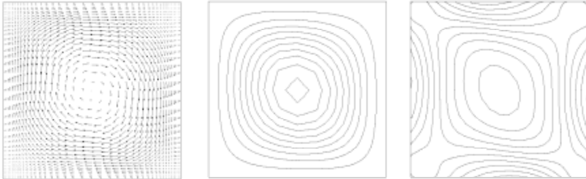
Sl. 2. Naravna konvekcija nenewtonske viskoelastične tekočine modelirana z zgornje konvektivnim Maxwellovim reološkim modelom ( \lambda_1=0,07 ); vektorji hitrosti (levo), tokovnice (sredina) in izolinije vrtinčnosti (desno)
