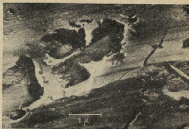
Sl. 18. Elektronsko mikroskopski posnetek obrabe pri zelo veliki obremenitvi
