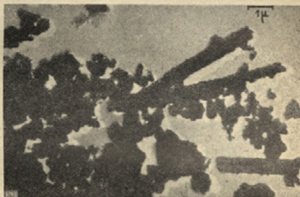
Sl. 19. Elektronsko mikroskopski posnetek delca, ki je nastal pri obrabi jekla
