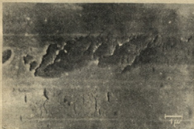
Sl. 15. Elektronsko mikroskopski posnetek okvarjene površine pri večji obremenitvi
