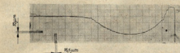
Sl. 8. Ponovljivost naprave za otipavanje — obraba na stružnem nožu po 30 minutah dela
