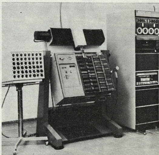
Sl. 3. Neposredno računalniško krmiljeni sistem »Ančka« za ožičenje telefonskih central
