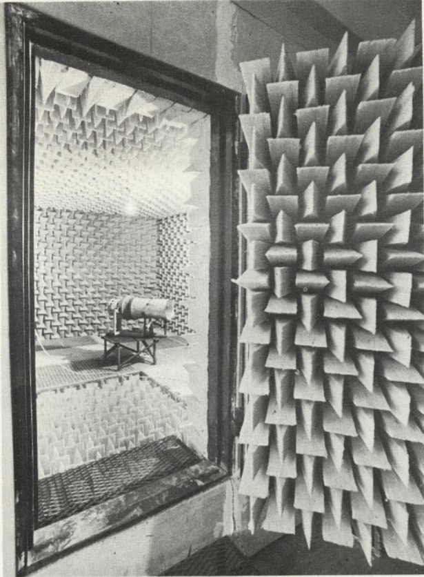
Gluha komora v laboratoriju PRE za energetska strojništvo
