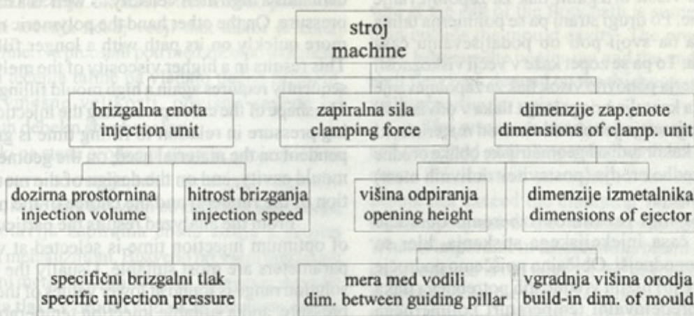
Sl. 1. Razčlenitev stroja za injekcijsko stiskanje glede na značilne veličine
