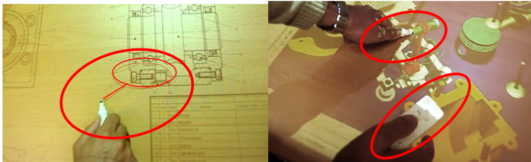
Sl. 4. Pero za označevanje (levo), pero in naprava Wiimote pri 3D-situaciji (desno)
