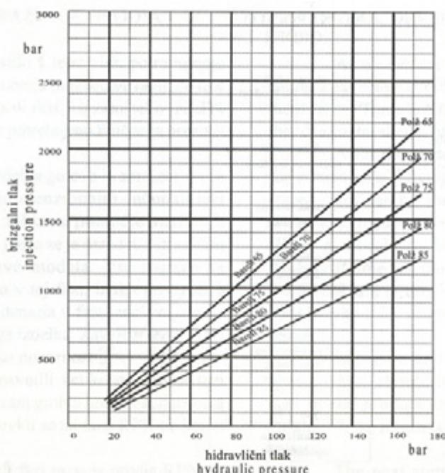
Sl. 3. Ovisnost med hidravličnim tlakom in brizgalnim tlakom [3]
