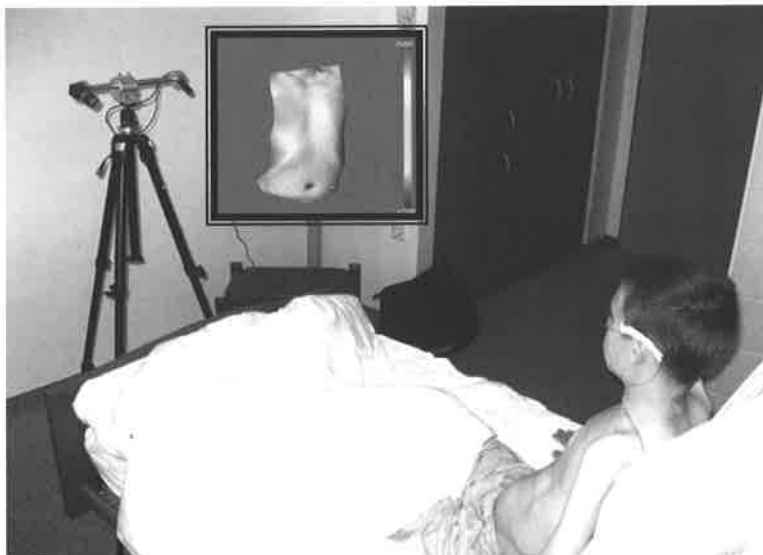
Slika 1. Laserski večlinijski triangulacijski sistem za hitro merjenje 3-D oblike prsnega koša med dihanjem
