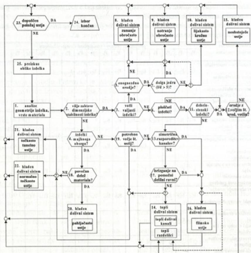
Sl. 3. Odločitveni diagram za projektivno določitev dolivnega sistema in ustja v orodju [11]
