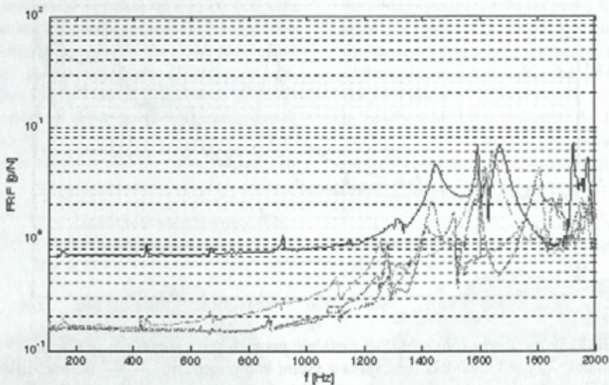
Sl. 5. Primerjava ovojnici FOF-ij različnih spremenjenih osnovnih izvedb usmernika
