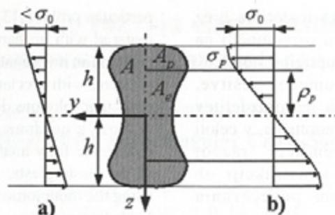
Sl. 1. Porazdelitev napetosti pri problemu upogiba nosilcev: a) elastična, b) elastoplastična
