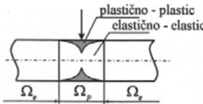
Sl. 2. Razdelitev na elastična in elastoplastična polja vzdolž nosilca
